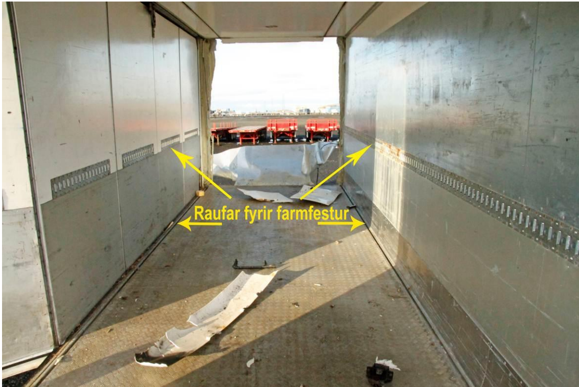
Mynd 2: Mynd tekin inná úr kælikassanum. Sjá má hvernig framgaflinn rifnaði allur af.
