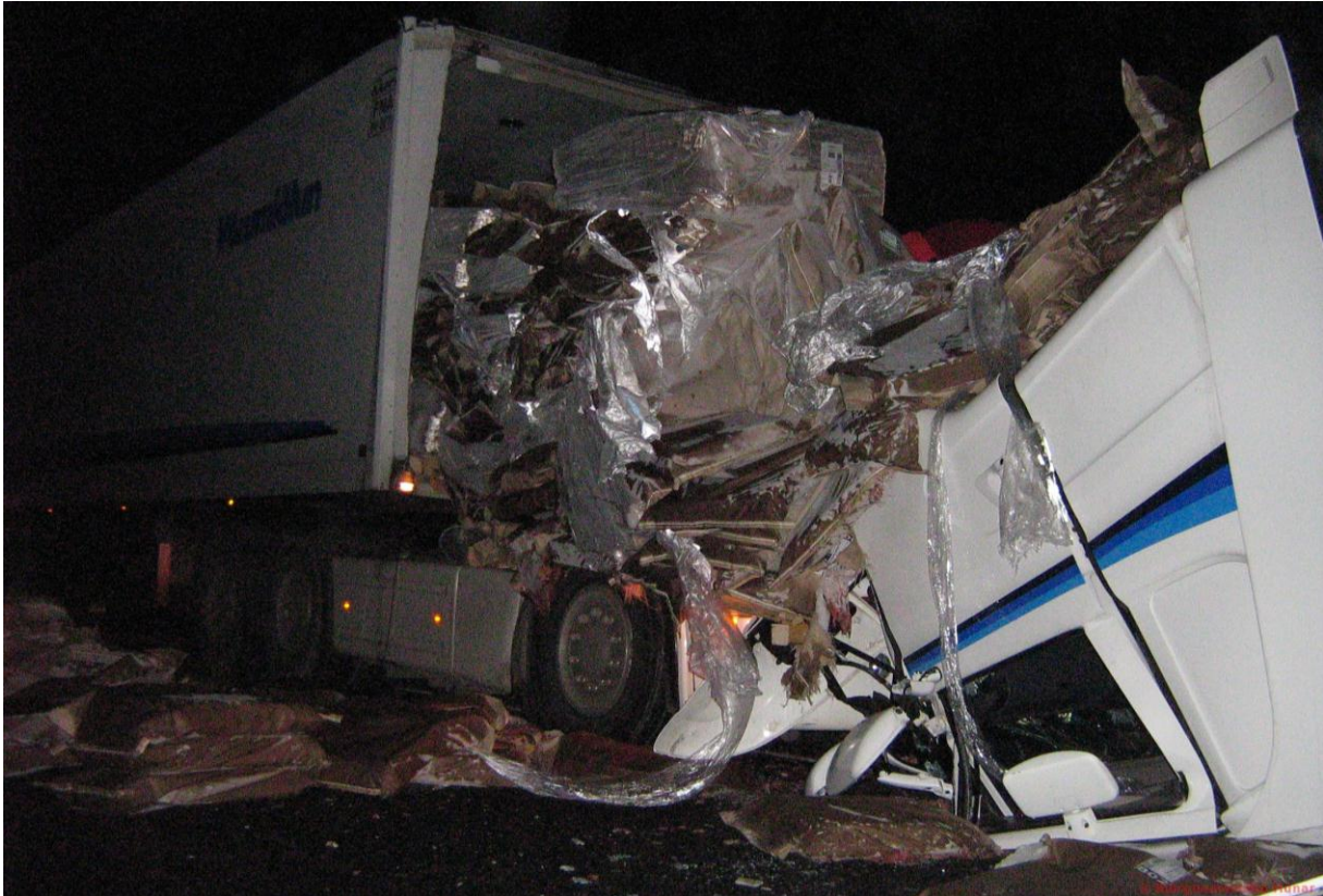
Mynd 1: Bifreiðin á slysavettvangi. Sjá má hvernig farmurinn braut niður framgafl kælikassans og braut því næst stýrishús bifreiðarinnar af. Myndin er fengin af vef björgunarsveitarinnar Húnar.
