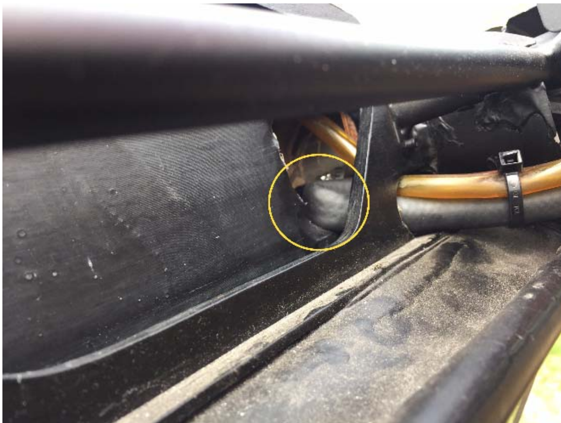
Mynd 2: Klemmd eldsneytisleiðsla í hægri vængrót
