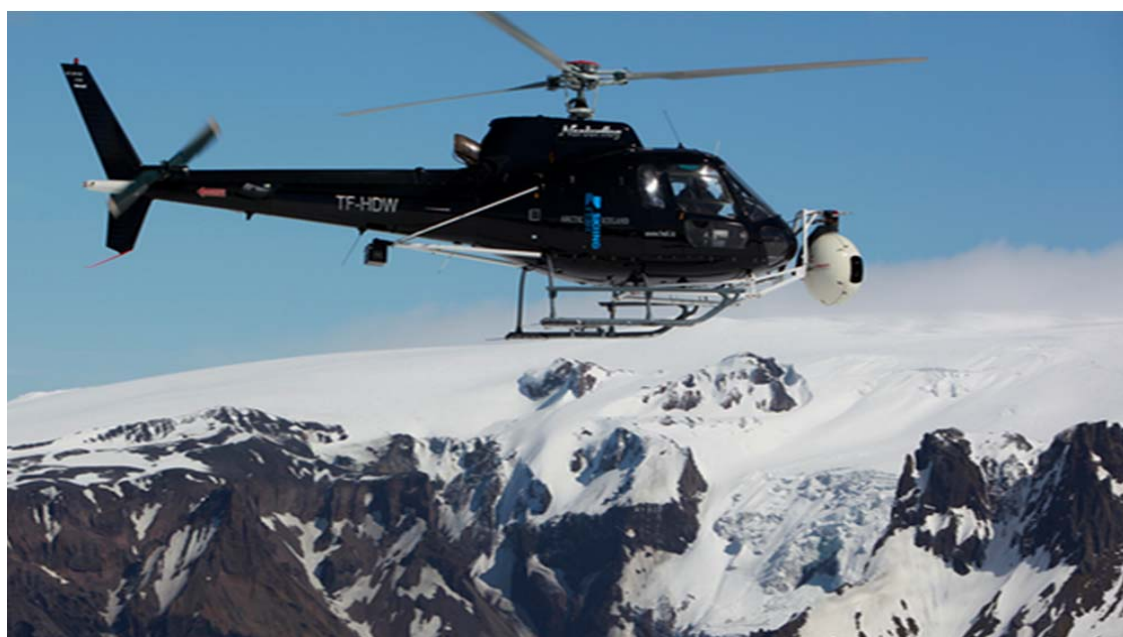
Mynd 1: TF-HDW útbúin kvikmyndatökubúnaðinum (kvikmyndavélarkúla framan á þyrlu og kjölfesta undir stélbómu)
