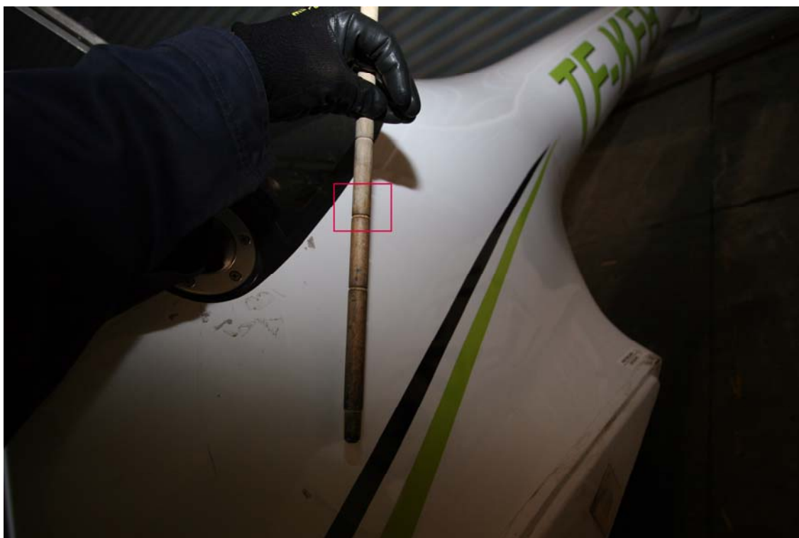
Mynd 1: Staða á eldsneytismælistika TF-KFB með 12 USG í eldsneytisgeymi
