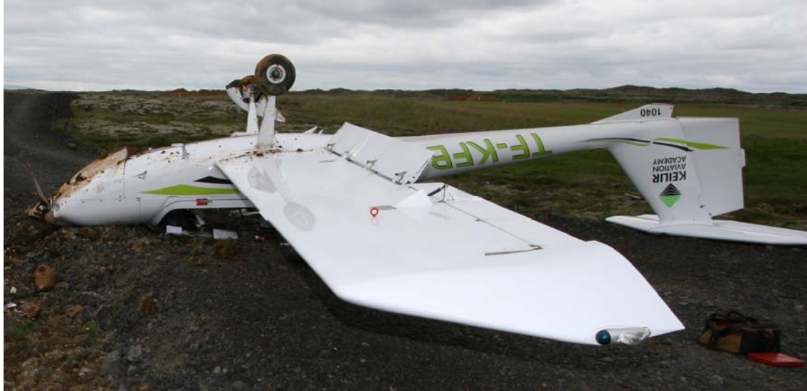
Mynd 3: Plastkúpull stjórnklefa brotnaði þegar flugvélinni hvolfdi
