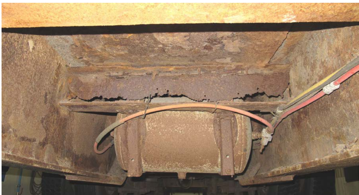
Mynd 6: Þverbitar undir vagninum voru sundurryðgaðir.
