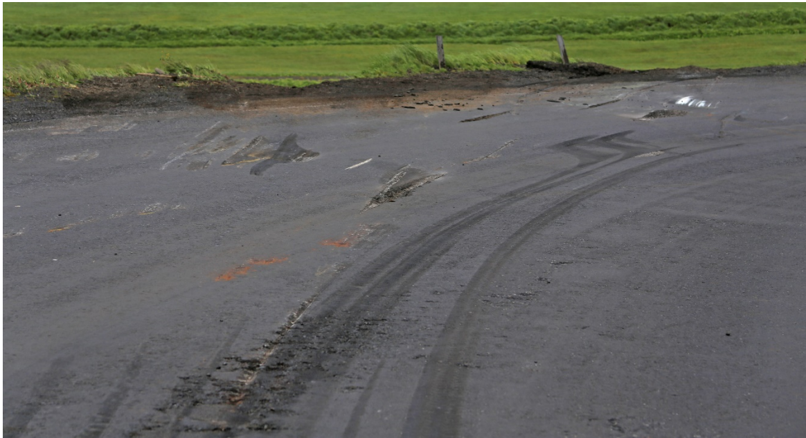
Mynd 8: Mynd af hemlaförum á vettvangi. Sjá má á hvar afturásar vörubifreiðarinnar renna til hliðar við enda faranna.
