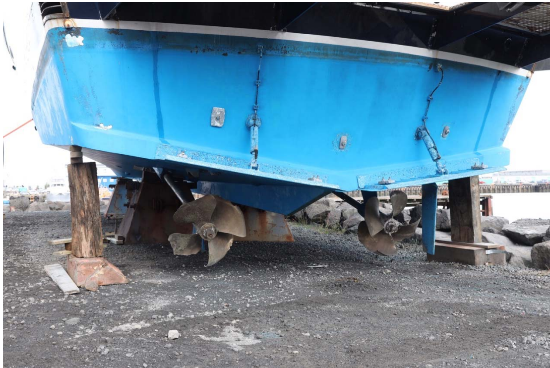
Mynd 2 Myndin sýnir tjón á skrúfum og stýrisbúnaði
