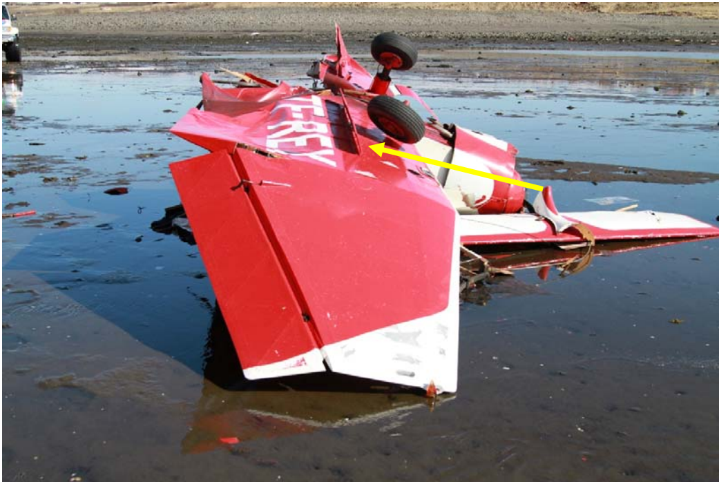
Mynd 2: Lofthemlar eru staðsettir undir væng á flugvélinni og voru á eftir brotlendingu
