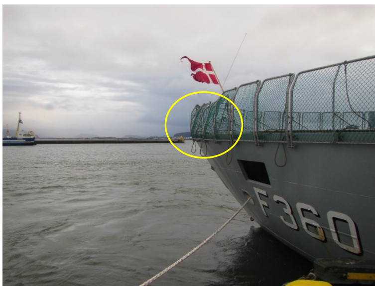
Mynd 3 Rekkverk skemmdist á skut Hvidabjörns
