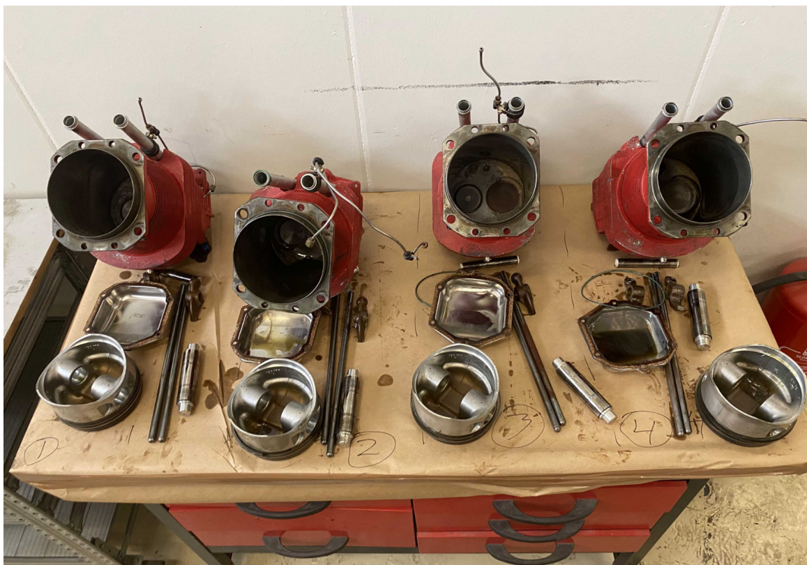
Mynd 5: Íhlutir hreyfilsins voru í lagi
