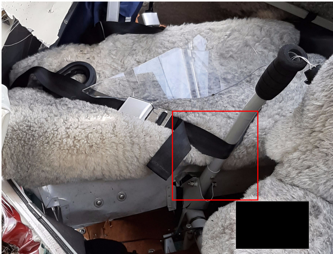
Mynd 10: Aftari stýripinni kyrfilega festur með sætisbelti 5
