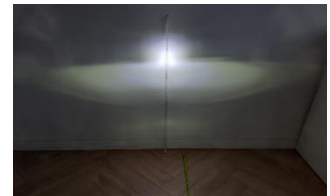
Mynd 6. Sýnir dreifingu lága og háa ljósgeislans á vegg í 1,5 metra fjarlægð.
