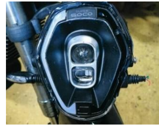
Mynd 5. Fram- og stefnuljós léttu bifhjólsins. Sjáanlegar eru skemmdir á ljósinu m.a. á vinstri díóðu og vinstra stefnuljósi.
