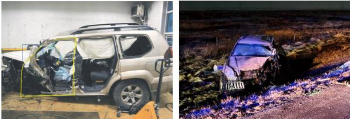
Mynd 2. Samsett mynd sýnir skemmdir vinstra megin á Toyota bifreiðinni og aflögun inn í farþegarými. Á vinstri myndinni sýna gular línur ætlaða staðsetningu vinstri framhurðar á bifreiðinni. Á hægri myndinni, sem tekin er á slystað, er búið að velta bifreiðinni af hægri hlið yfir á hjólin.
