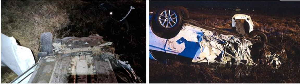
Mynd 3. Samsett myndin sýnir skemmdir á vinstra framhorni Volvo bifreiðarinnar.
