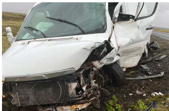
Mynd 5. Samsett mynd. Vinstri myndin sýnir skemmdir á vinstra framhorni sendibifreiðarinnar. Hægri myndin sýnir um eins metra löng dragfór á jarðvegi eftir hægri afturhjóli þegar bifreiðin hafnaði utan vegar.
