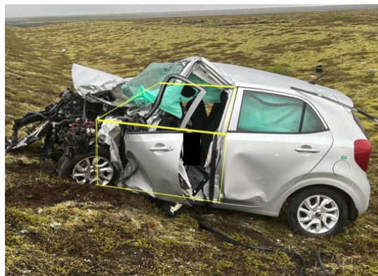
Mynd 4. Samsett mynd. Myndin til vinstri sýnir skemmdir hægra megin á Kia bifreiðinni þar sem lítil aflögun er inn í fólksrými farþegamegin. Hægri myndin sýnir skemmdir og aflögun ökumannsmegin inn í fólksrými bifreiðarinnar. Gular línur sýna ætlaða staðsetningu vinstri framhurðar á bifreiðinni fyrir áreksturinn.
