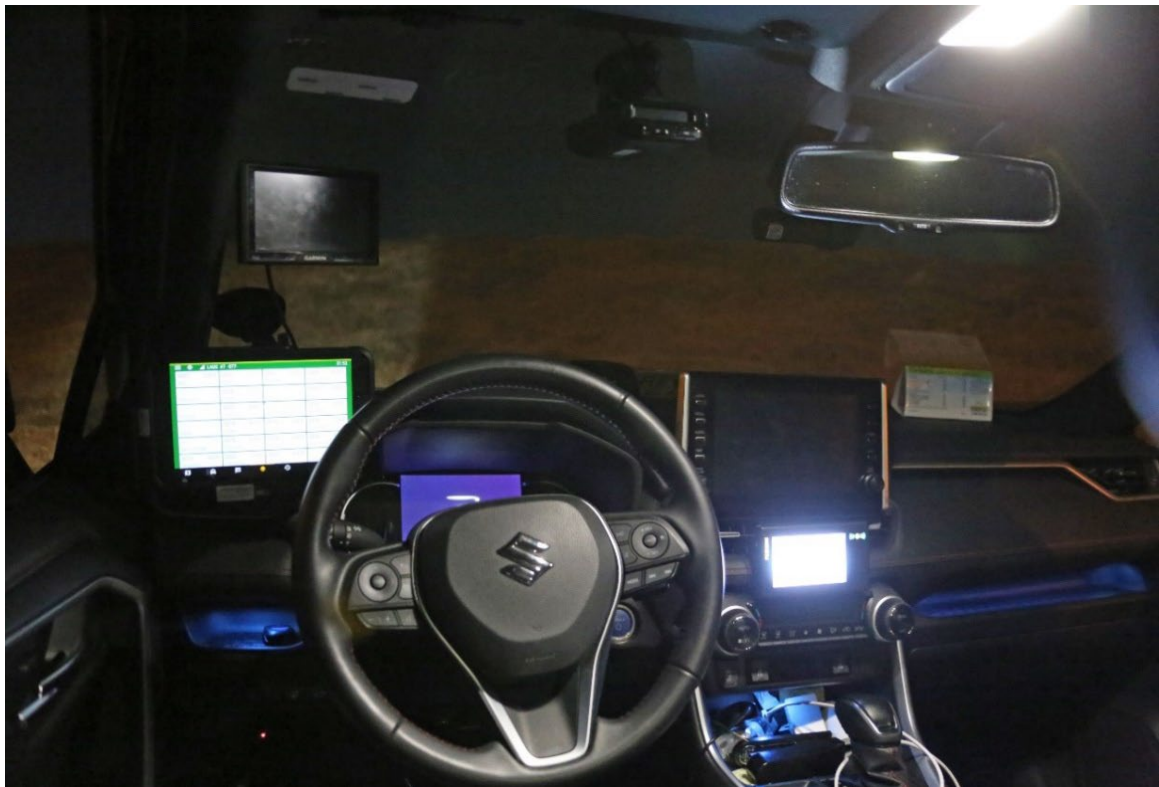
Mynd 2. Mynd tekin innan úr Suzuki bifreiðinni. Aukahluti má sjá við framrúðuna í sjónsviði ökumanns sem takmarka útsýn um framrúðuna.
