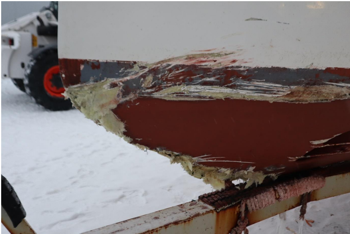
Mynd 7 skemmdir á stefni Hlakkar
