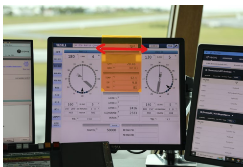
Mynd 6: Plast sem mögulegt er að hylja veðurupplýsingar um hvora flugbraut fyrir sig
