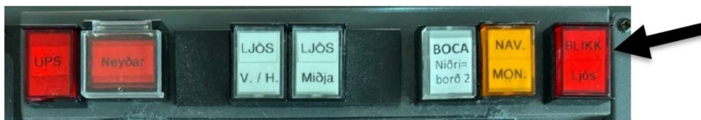
Mynd 2: Ljósaborð á vinnustöð í turni, ljósið sem örin bendir á er viðvörunarljós sem blikkar
