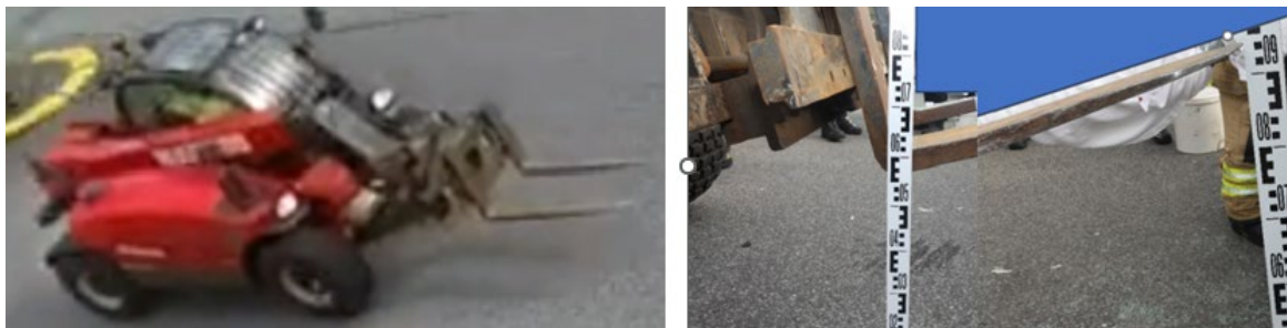
Mynd 6. Samsett mynd. Til vinstri má sjá vinnuvélina skömmu fyrir slysið. Til hægri er samsett mynd af göfflum vinnuvélarinnar eftir slysið.
