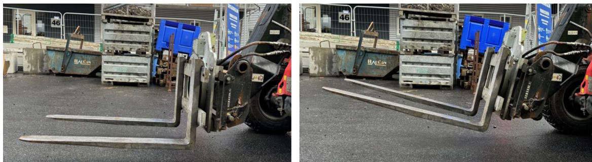
Mynd 8. Samsett mynd: Mynd til vinstri sýnir samskonar gaffla vinnuvélarinnar í láréttri stöðu en mynd til hægri í efstu stöðu.
