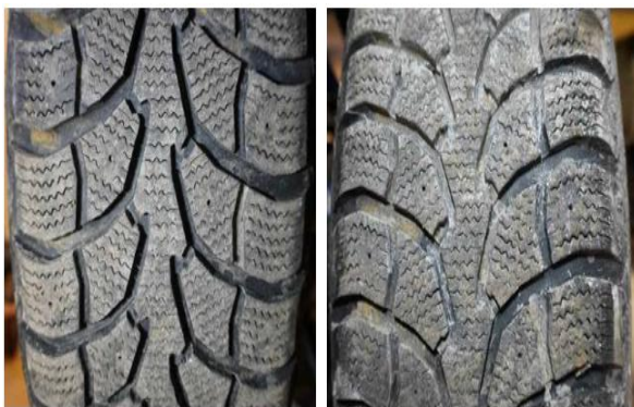
Mynd 4. Hjólbarðarnir að aftan voru nánast óslitnir.
