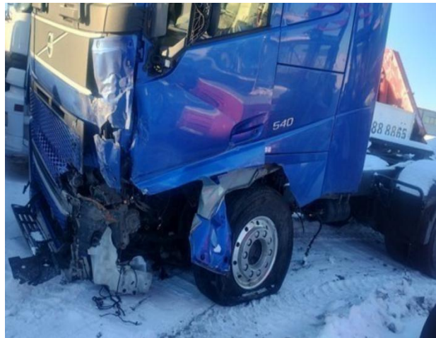
Mynd 3. Skemmdir á vinstra framhorni vörubifreiðarinnar en framhjól gekk aftur og neðri hluti hurðar rifnaði af.
